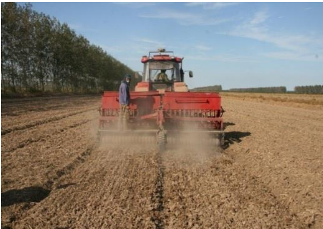
插图 2：本地播种机：旋耕播种一体机
