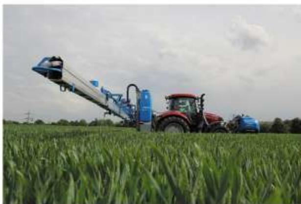
现代悬挂式喷雾器的储罐容量可达2200升，工作宽度为18至27 m。如果还有前水箱，则可输送总量约为3000升的水。在用水量为220-250升/公顷的情况下，机器最多可对12-15公顷（180至225亩）的土地进行喷洒工作。轮轴负载，轮辋的负载能力和拖拉机的发动机功率必须与满载的喷雾器的总重量匹配。装载2200升水并带有800升水的前水箱的喷雾器总重量约为3500至4000公斤。
